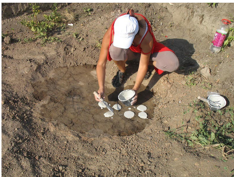
Обр. 3. Оформяне на гипсови площадки върху предварително избраните участъци. Fig. 3. Shaping of gypsum plasters over the pre-selected areas
