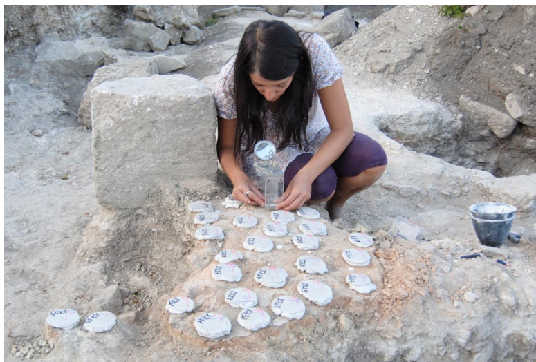
Обр. 5. Ориентиране на образците с помощта на магнитен компас
