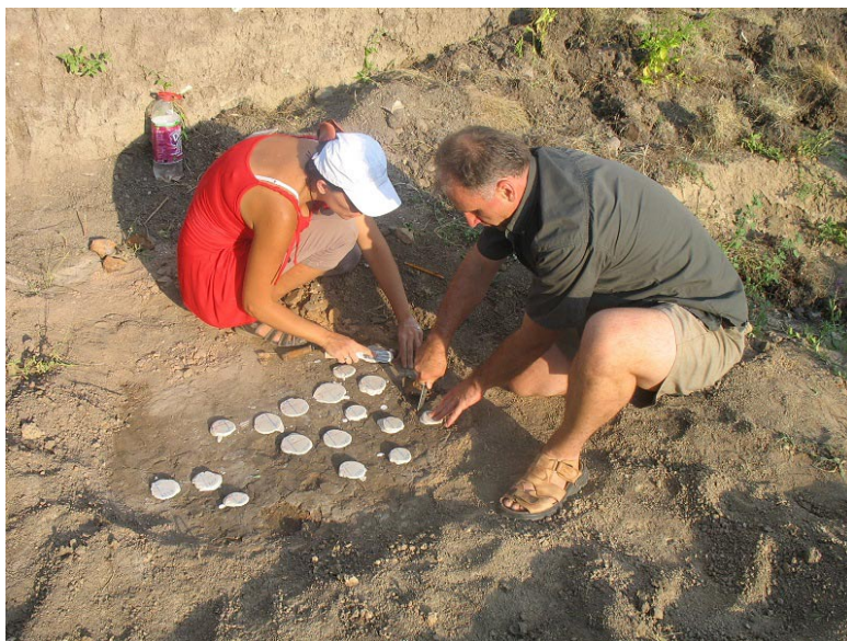
Обр. 8. Внимателно отделяне на образците заедно с ориентираните замазки
